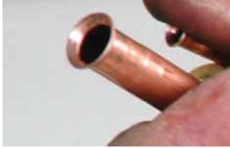
Figure 6.11 Flare the end of the tube (D)
